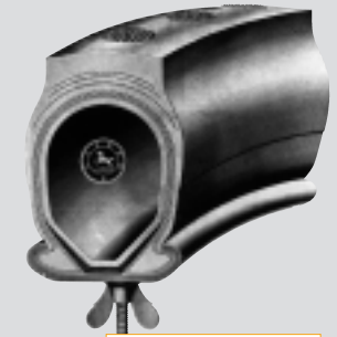
Corte de un neumático de 1910
